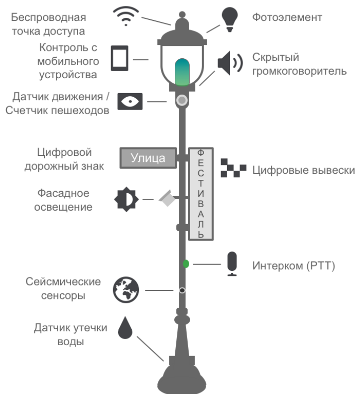
Рисунок 8. Умный фонарь и его компоненты
